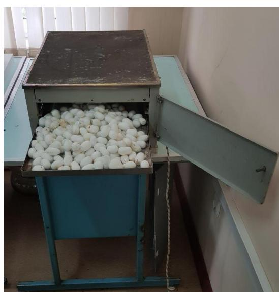
**Рис.2. Первичная переработка коконов тутового шелкопряда с помощью ИК-нагрева**
