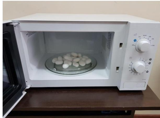
**Рис.3. Первичная переработка коконов тутового шелкопряда с помощью СВЧ**
