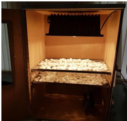
**Рис.4. Первичная переработка коконов тутового шелкопряда с помощью горячего воздуха (конвективная)**
