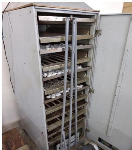
**Рис.5. Первичная переработка коконов тутового шелкопряда с помощью ИК-вибрации**
